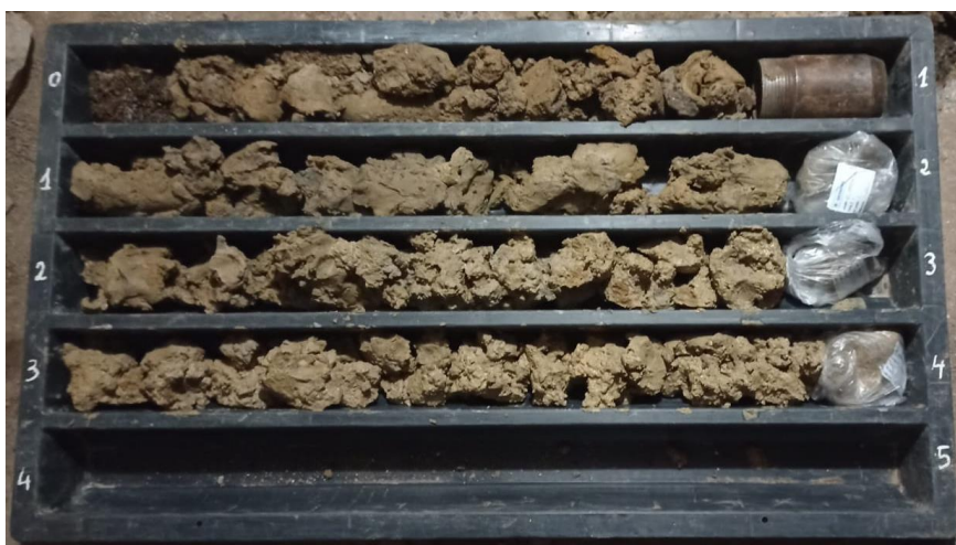
Figura 9. Fotografie cu terenul din amplasament rezultat în urma forajului geotehnic
